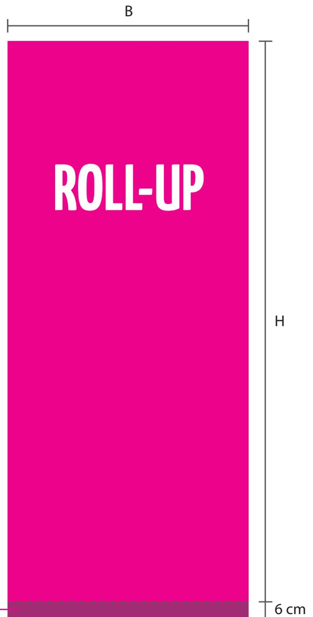
Bereich wird im Gehäuse verbaut
